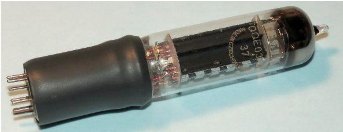
In un post precedente ho presentato un circuito equivalente MOSFet per il pentodo a doppia potenza ELL80 NF. Anche se non si riesce a percepire che sono i MOSFet a funzionare al posto di una valvola nello stadio di uscita audio, la vista di un circuito equivalente collegato allo zoccolo della valvola è un po' sorprendente e non è nemmeno molto autentica.
