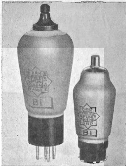
Fig. 5.7. - Valvole Telefunken. A sinistra: un tipo vecchio; a destra: un tipo recente.
