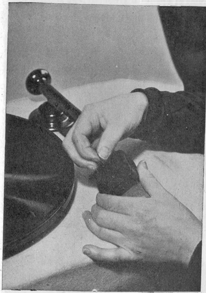
Fig. 7.14. - Esempio di rivelatore fonografico.
